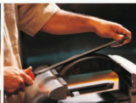
HAND - Plate à main - Plana paralela
